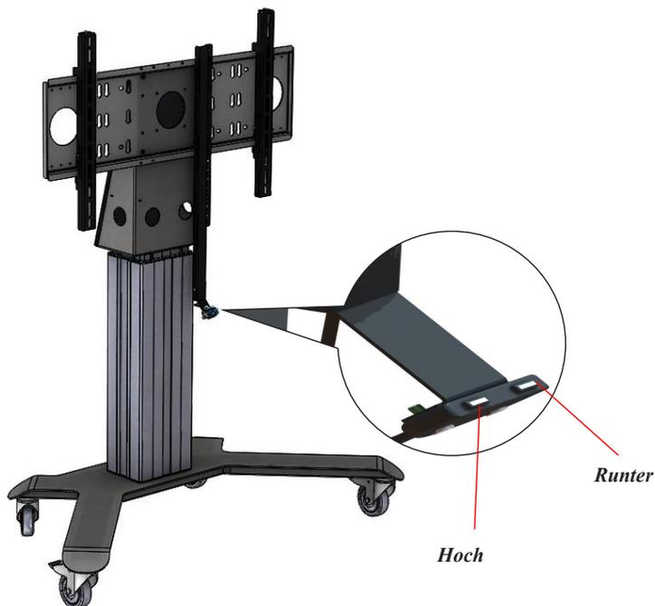
3. Verschrauben Sie den Schalter / Schalterblech (D) mit dem Haupthalter, die Befestigungshöhe ist von der Höhe des Displays abhängig. Kabel mit Kabelbindern fixieren.
